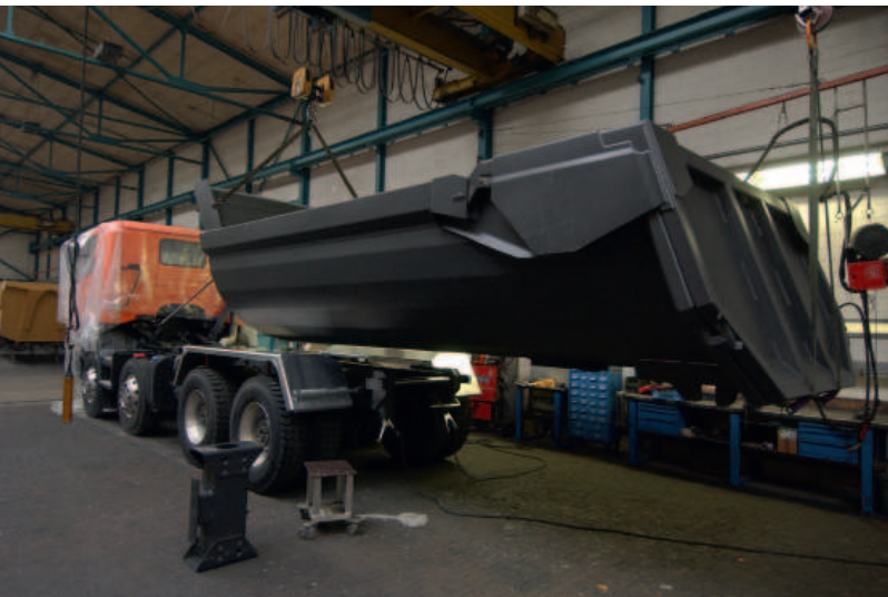
Kippaufbau ohne Hilfsrahmen: Stattdessen wurde das Scania-Chassis bereits im Werk an den neuralgischen Punkten verstärkt.
