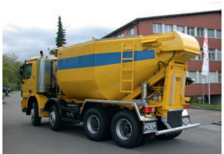
Betonmulde Typ M-15B mit Isolation und Deckel für die Firma De Paola AG, Aesch/Birmensdorf.
