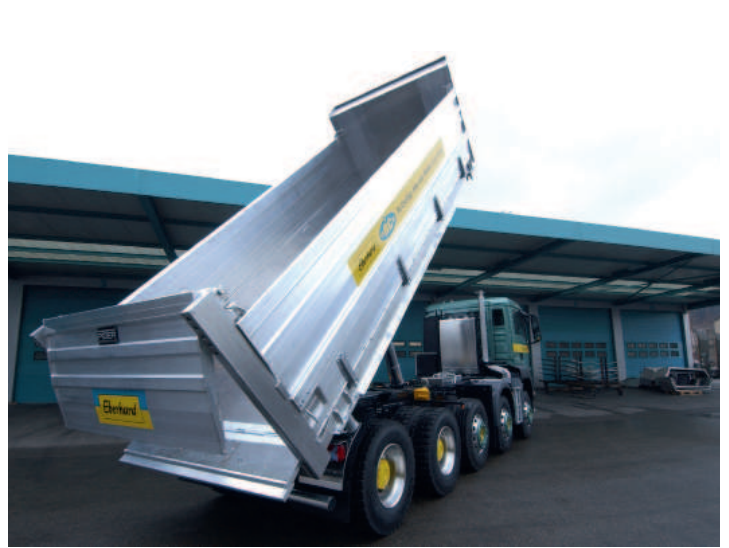
Peter/Eberhard-Dreiseitenkipper mit Seitenladenautomaten, Alu-Ausführung für 1,5 t mehr Nutzlast, auf 5-Achser-MAN-Chassis für die Firma Eberhard Bau AG, Oberglatt.
