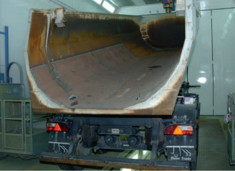
Kipper-Instandstellung dank Einsatzes neuer Bodenbleche.
