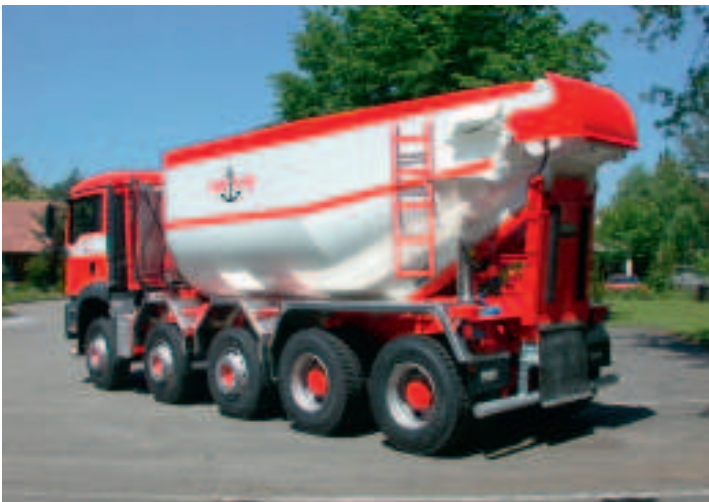
Peter-Betonmulde Typ M-18B (18 m 3 ) für die Firma Schätzle AG, Luzern, auf 5-Achser-MAN-Chassis. Für die Fünfachser sind sogar 20 m 3 grosse Mulden erhältlich.
