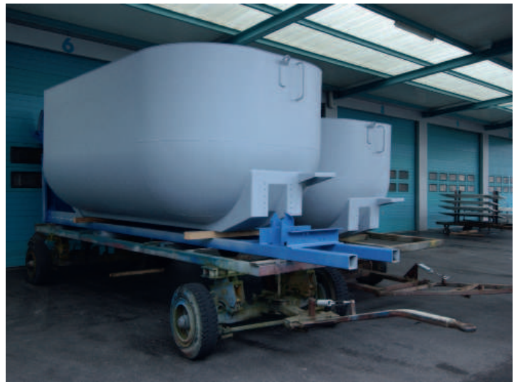
Mulden im Rohbau aus Schweizer Fertigung.
